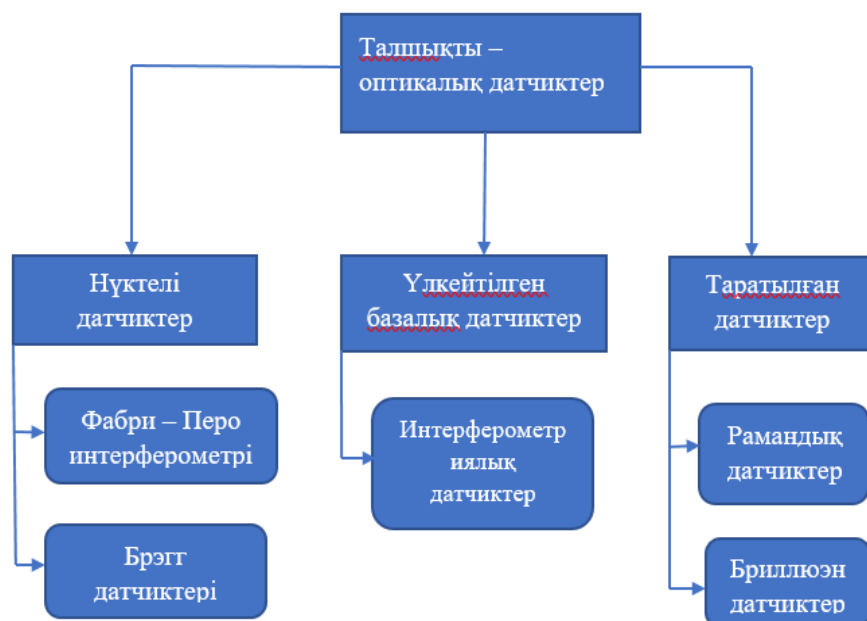
Сурет 2.5– Деформацияны өлшеуге арналған талшықты-оптикалық датчиктердің жіктелуі [74]
